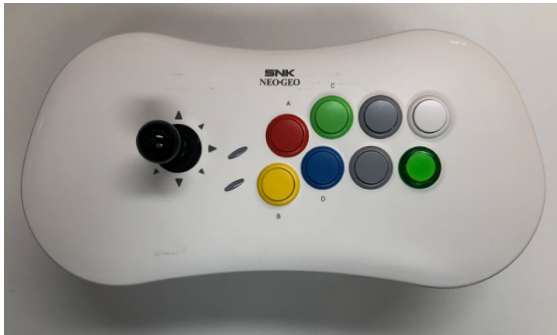
네오지오 ASP용 삼덕사 레버 및 삼덕사 SDB-201C 버튼으로 교체한 모습
