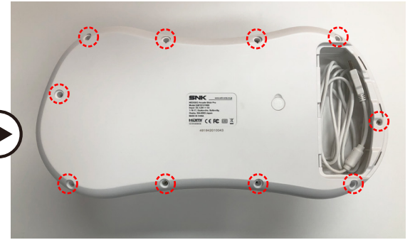
③ 제품 하단을 덮고 10개의 나사를 결합 후 케이블 덮개와 고무 패드를 결합시켜줍니다.
